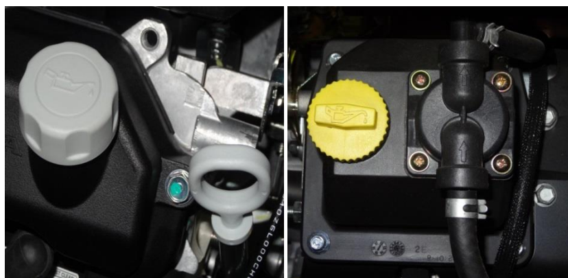
Kontrola množství oleje – pro modely SP2-4H a TP5-7H
